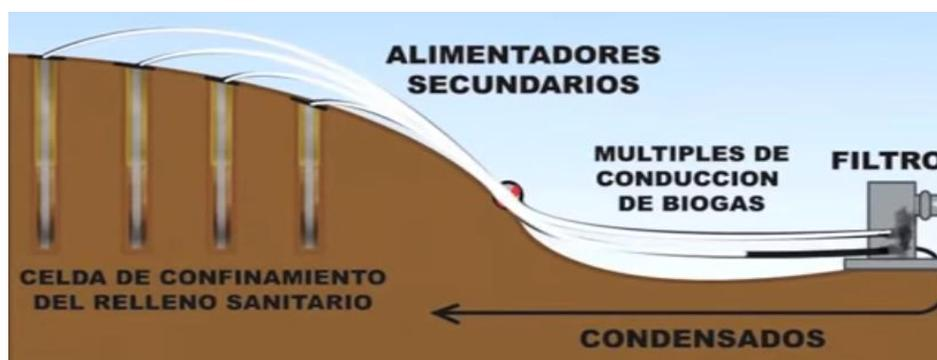
Figura 11. Captación y conducción del biogás
