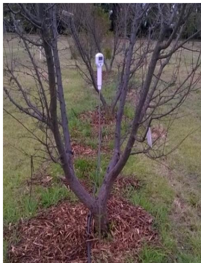
Figura 5. Medición de la temperatura máxima y mínima del suelo a los 30 y 50 cm de profundidad.
