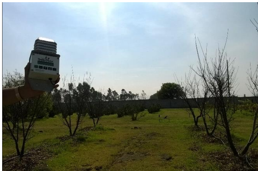
Figura 7. Medición de la radiación incidente con rastreador de clima.
