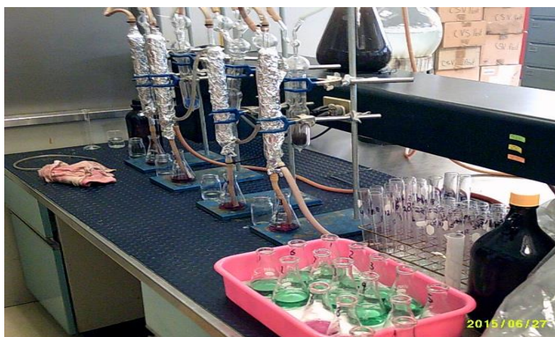
Figura 17. Determinación del contenido de nitrógeno foliar con un destilador Kjeldahl.
