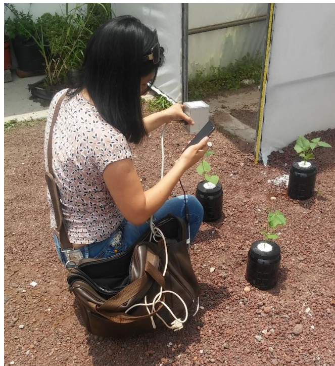
Figura 9. Toma de lecturas de reflectancia con radiómetro CROPSCAN.
