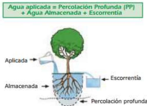
**Figura 29.** Esquema de variables incluidas en el cálculo de la eficiencia de aplicación.
