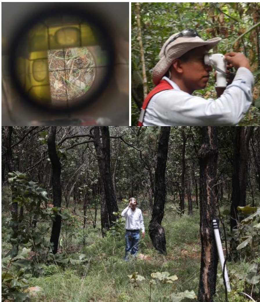
Figura 16.- Uso del densitómetro para medición de cobertura del piso y de dosel, Samuel García.
