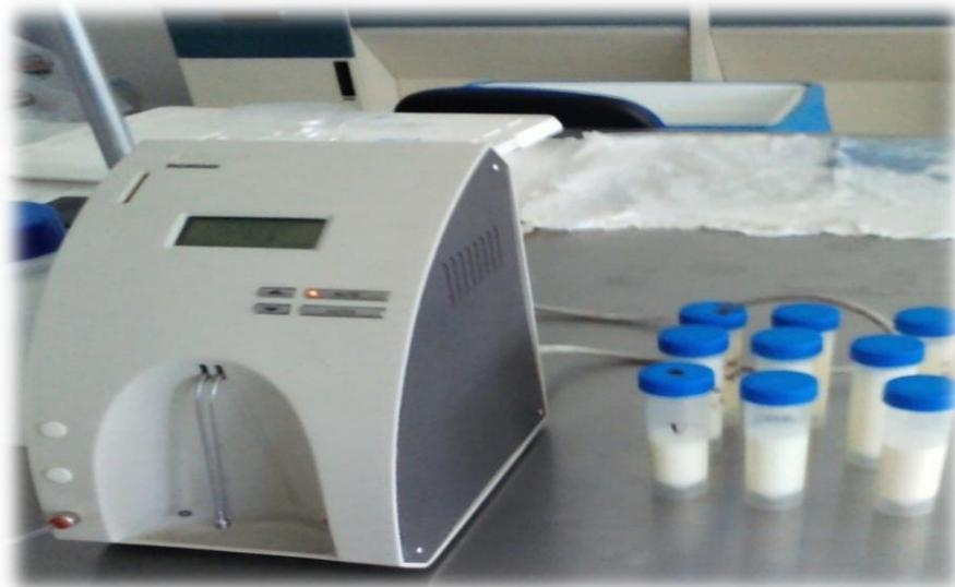
**Figura 8. Analizador de leche Milkoscope Julie C3® (Scope Electric, 2010)**
