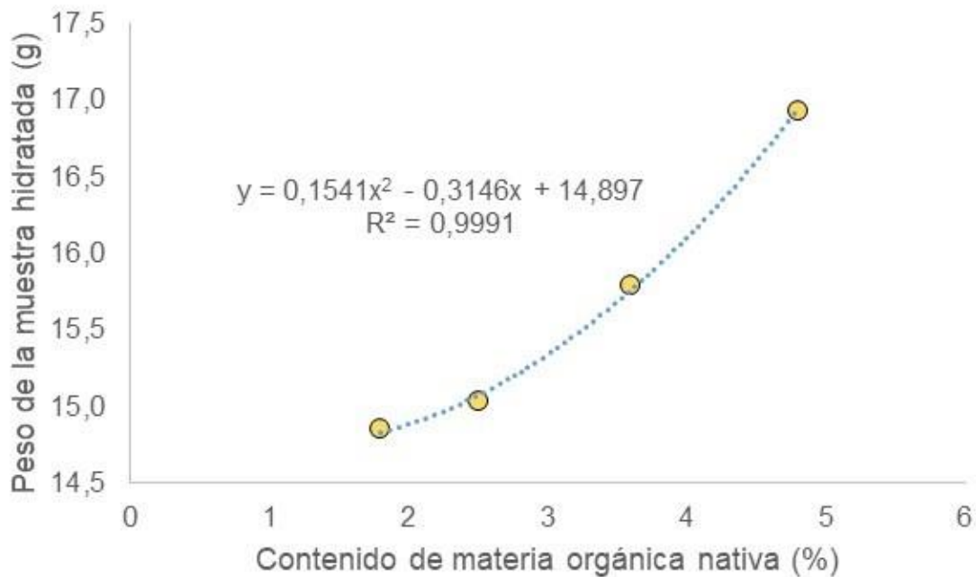
Figura 5.3. Tendencia observada entre el peso del suelo medido inmediatamente posterior a su hidratación inicial, respecto a su correspondiente contenido de materia orgánica nativa (suelos con 40.3\% \pm 3.3\% promedio de arcilla y desviación estándar, respectivamente).
