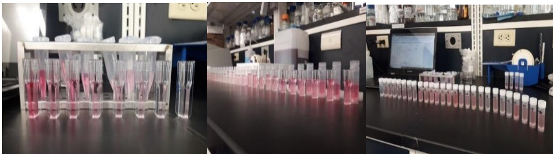
Figura 4. Análisis de sustancias reactivas al ácido tiobarbitúrico (TBARS) de patties de pechuga de pollo, almacenadas a 4 °C, bajo diferentes tratamientos: T1 , 0 mg de CoQ 10 en ME, T2 , 100 mg de CoQ 10 en ME, T3 , 200 mg de CoQ 10 en ME, T4 , 300 mg de CoQ 10 en ME, por 100 g de carne.
