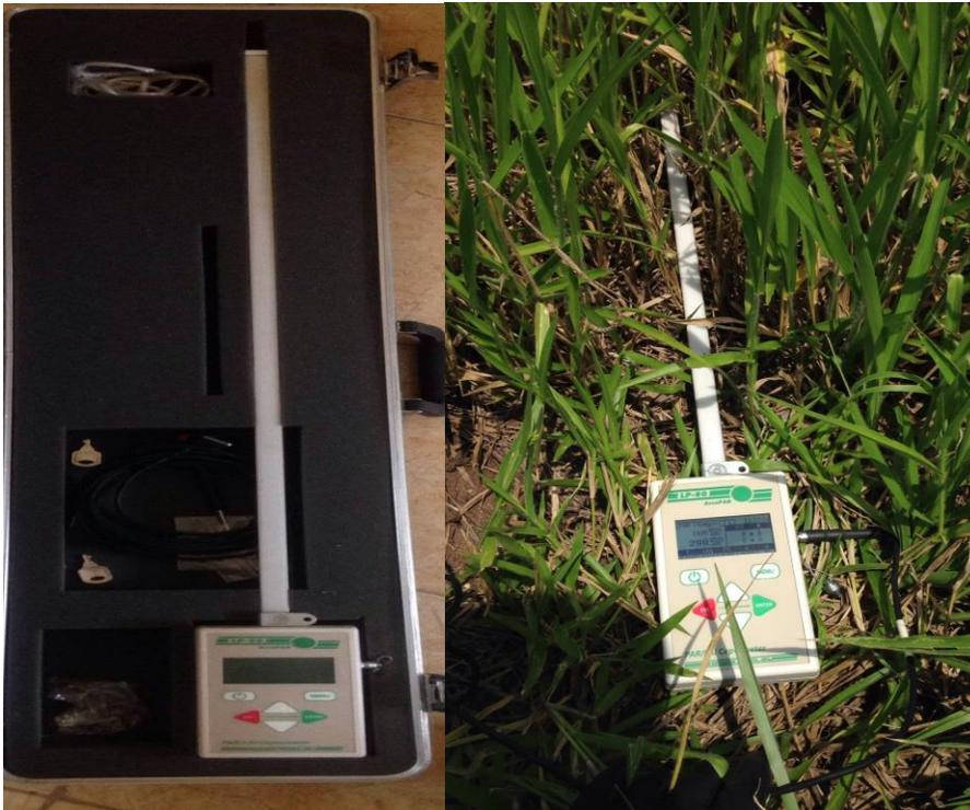
Figura 2.- Ceptómetro AccuPAR Model LP-80 empleado para las mediciones de intercepción luminosa.
