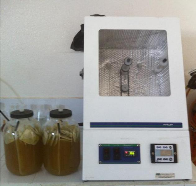
Figura 5.- Incubadora Daisy Ankom para determinación de digestibilidad *in vitro*.
