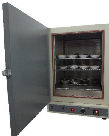
Figura 12. Secado de raíz a 70 °C en horno de secado (TERLAB® modelo TE-H68D, serie 090325).
