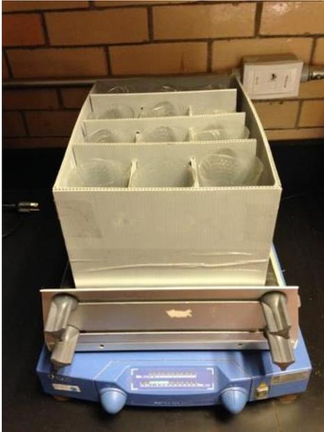
**Figura 6.** Agitador mecánico utilizado para desprender los ácaros de las abejas.
