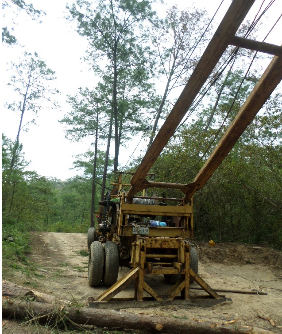
Figura 6. Motogrúa usada en el arrastre de trocería. Foto MMendoza.
