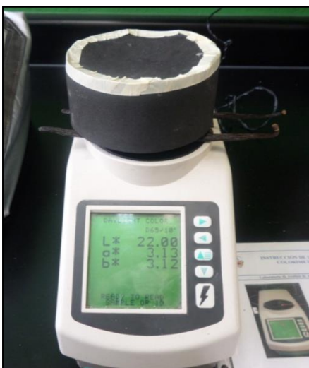
Figura 16. Análisis de color de vainas con colorímetro Hunter Lab.
