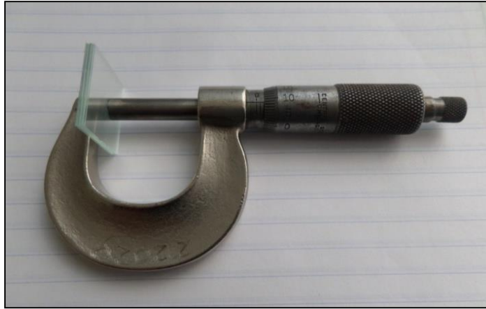
Figura 19. Medición de espesor de las películas plásticas con micrómetro manual.
