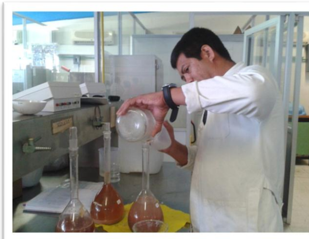
ANEXO B-2. Experimento para determinar densidad, viscosidad y temperatura en las soluciones de agua-fertilizante empleadas en las simulaciones.
