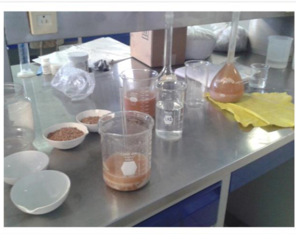
ANEXO B-2. Experimento para determinar densidad, viscosidad y temperatura en las soluciones de agua-fertilizante empleadas en las simulaciones.
