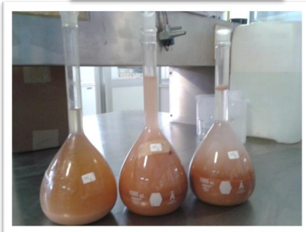
ANEXO B-2 (continuación). Experimento para determinar densidad, viscosidad y temperatura en las soluciones de agua-fertilizante empleadas en las simulaciones.
