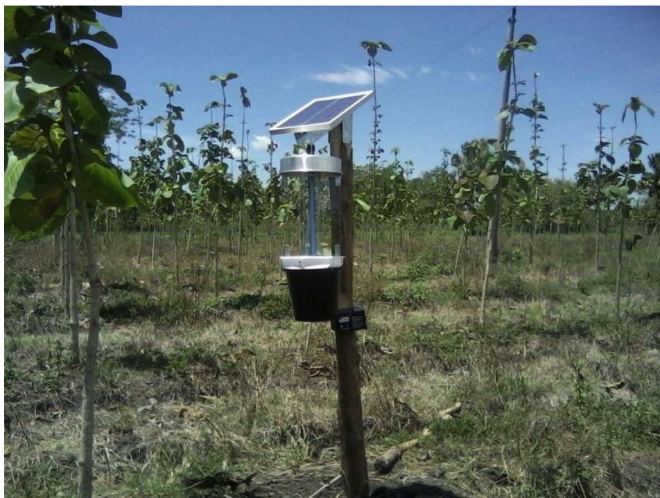
Figura 4.1. Trampa de luz automatizada diseñada específicamente para el monitoreo de H. puera en plantaciones de teca.
