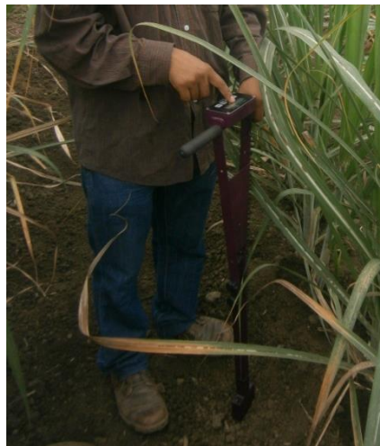
Figura 4. 1 Medición de humedad del suelo con el TDR300®.
