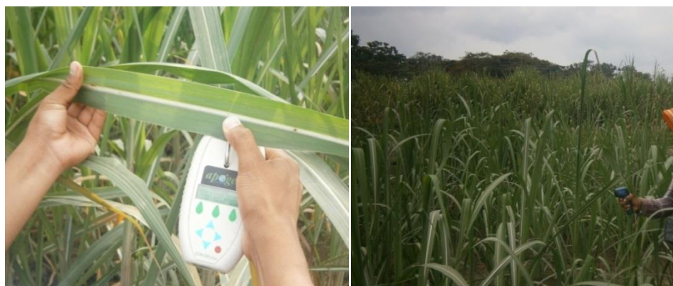
Figura 4. 3 Medición de contenido de clorofila con CCM200 plus® (izquierda) y de la temperatura con termómetro infrarrojo (derecha) en caña de azúcar.
