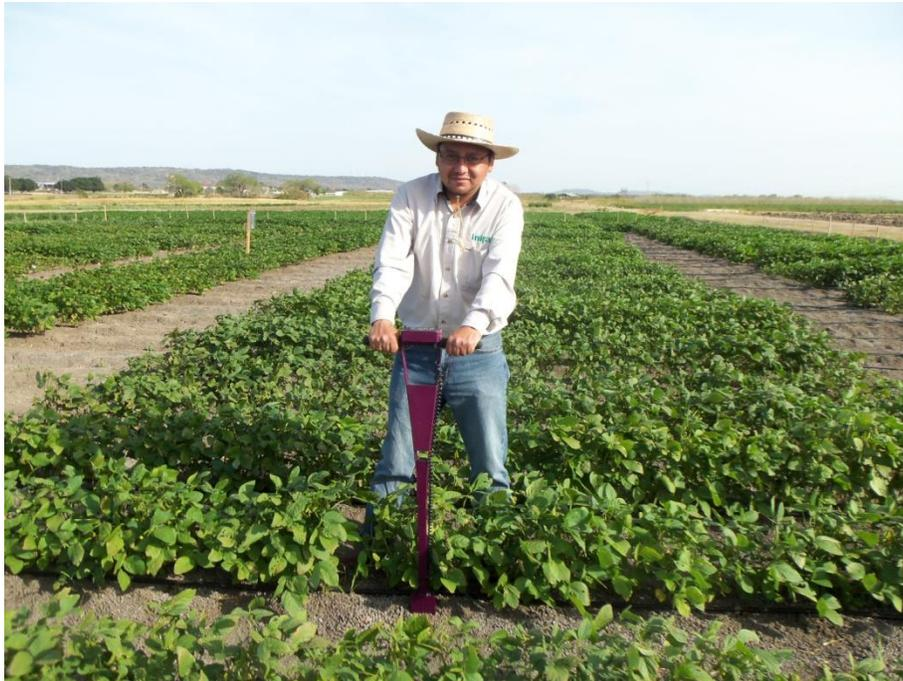
Se utilizó el TDR 300 (Spectrum Technologies Inc.) para medir el contenido volumétrico de agua por unidad experimental.
