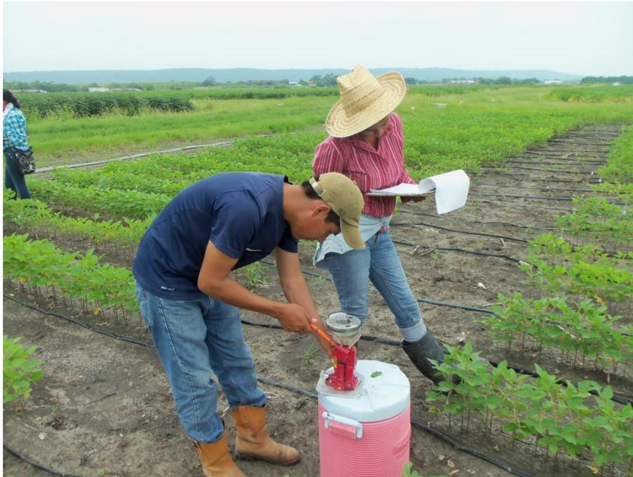
El potencial hídrico en el experimento de exceso de humedad se midió con una bomba de presión hidráulica tipo Scholander.
