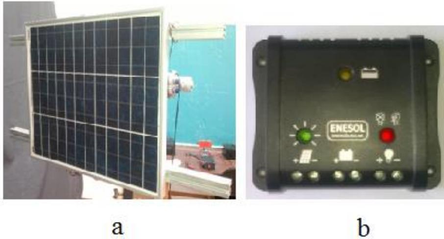
Figura 30. Componentes del sistema de captación de energía: a) panel solar, b) regulador de carga
