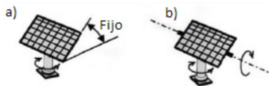
Figura 9. Configuración de ejes más utilizados en la práctica: a) montaje polar, b) montaje acimut-elevación
