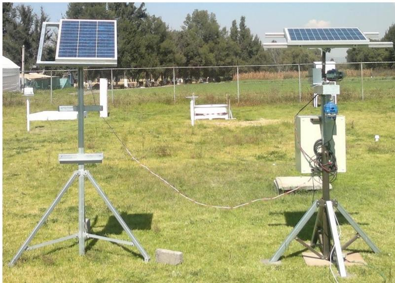
Figura 11. Panel fotovoltaico fijo (izquierda) y seguidor solar (derecha).
