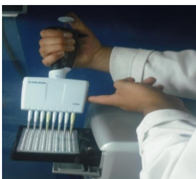
Figura 33. Figura de la forma de agregar el sustrato ABTS con ayuda de la micropipeta multicanales, del pozo A al H; por columna.
