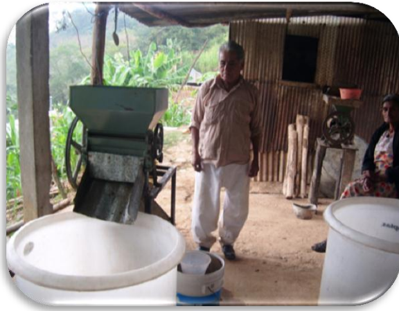
Despado de café con máquina eléctrica
