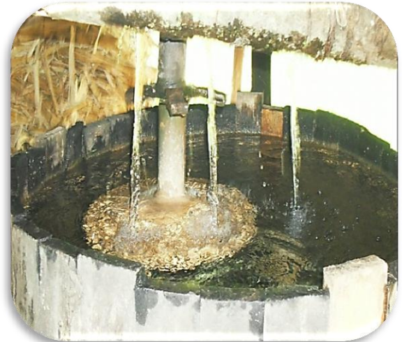
Tina de enfriamiento para la circulación del aguardiente
