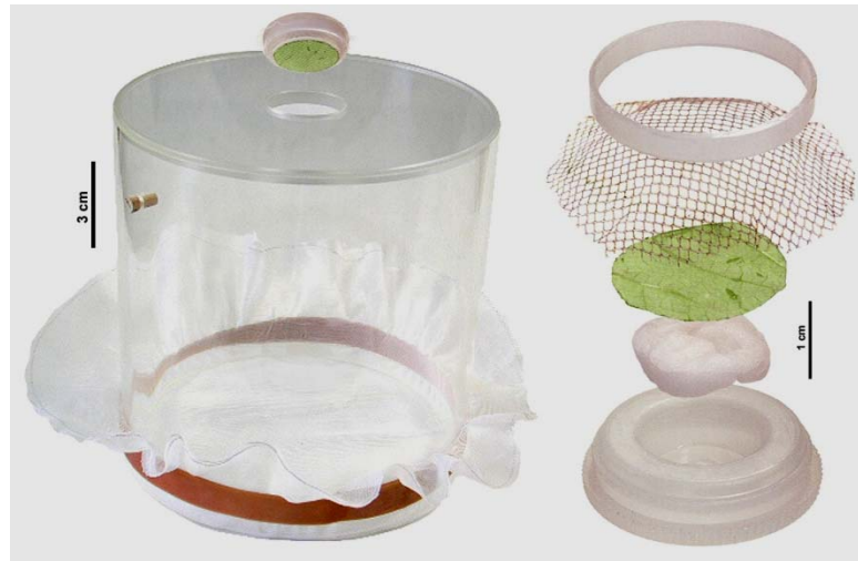
Figura 4. Cilindro de acrílico para la evaluación de repelencia de adultos de mosca blanca.
