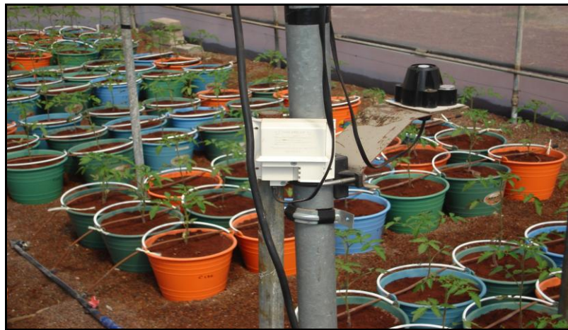
Fig. 5-9a Instalación de estación automática Davis mostrando sensores de temperatura y radiación solar
