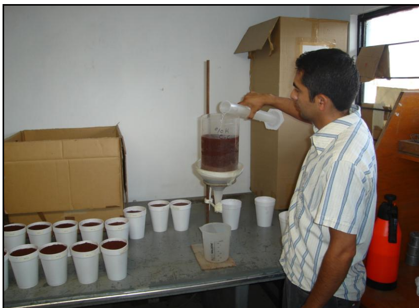
Fig. 5-14 Determinación de capacidad de campo en tezontle con granulometría fina con método empírico, en cinco muestras por tratamiento.
