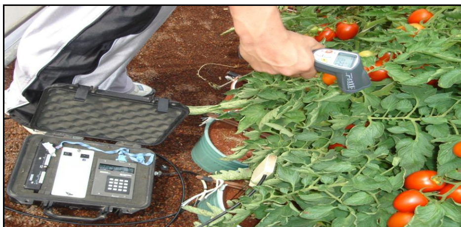
Fig. 5-12 Toma de datos de temperatura foliar y humedad del sustrato de forma simultánea
