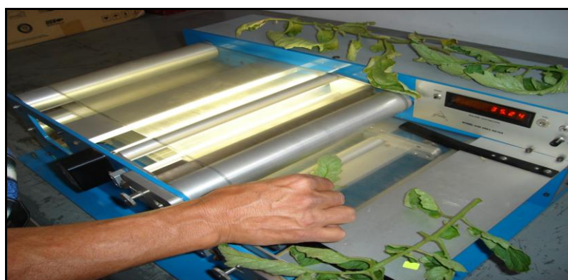
Fig. 6-19 Determinación de superficie de hojas mediante el uso del integrador de área foliar.
