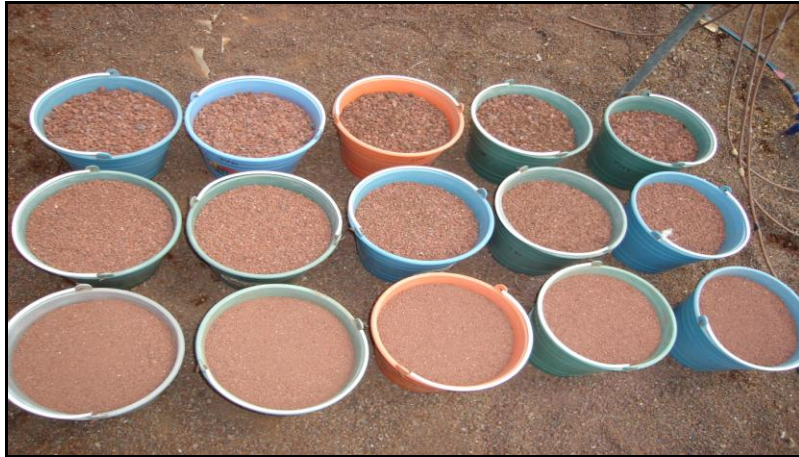
Fig. 5-5 Tezontle rojo con tres diámetros de granulometría usados en el experimento
