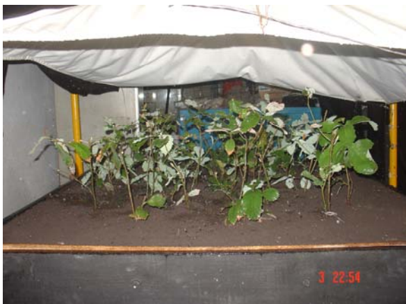
Figura B-15. Aplicación de 8.3mm de lluvia al cajón
