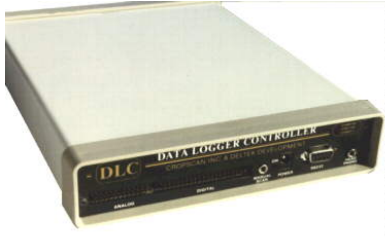
Figura A-19. Datalogger para almacenar información adquirida con el radiómetro multispectral CropsScan
