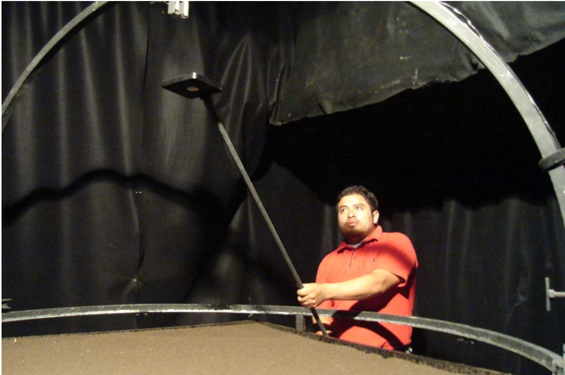
Figura B-37. Colocación del panel blanco de referencia para calibrar el ASD
