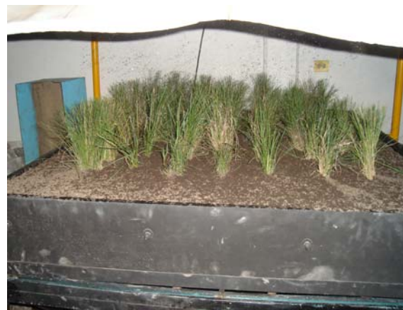
Figura B-15. Aplicación de 8.3mm de lluvia al cajón
