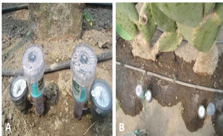
Figura 2. Implementación del experimento:(A) tensiómetros instalados, (B) riego de saturación del suelo antes de iniciar el experimento.
