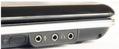
Figura 65. Puerto de audio de una computadora personal.
