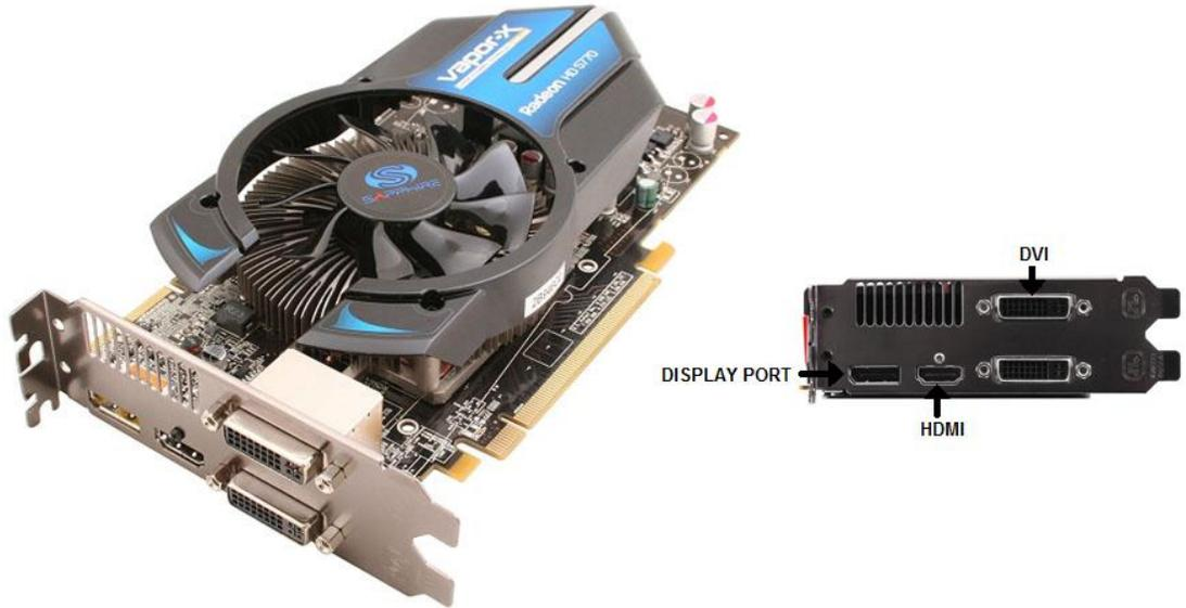
Figura 25. Tarjeta de Video ATI –RADEON HD5770.
