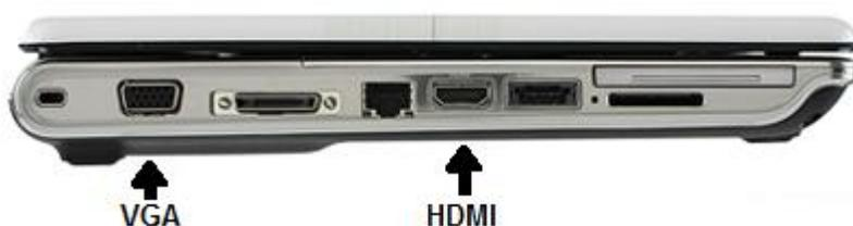
Figura 28. Puertos de video de una computadora personal.
