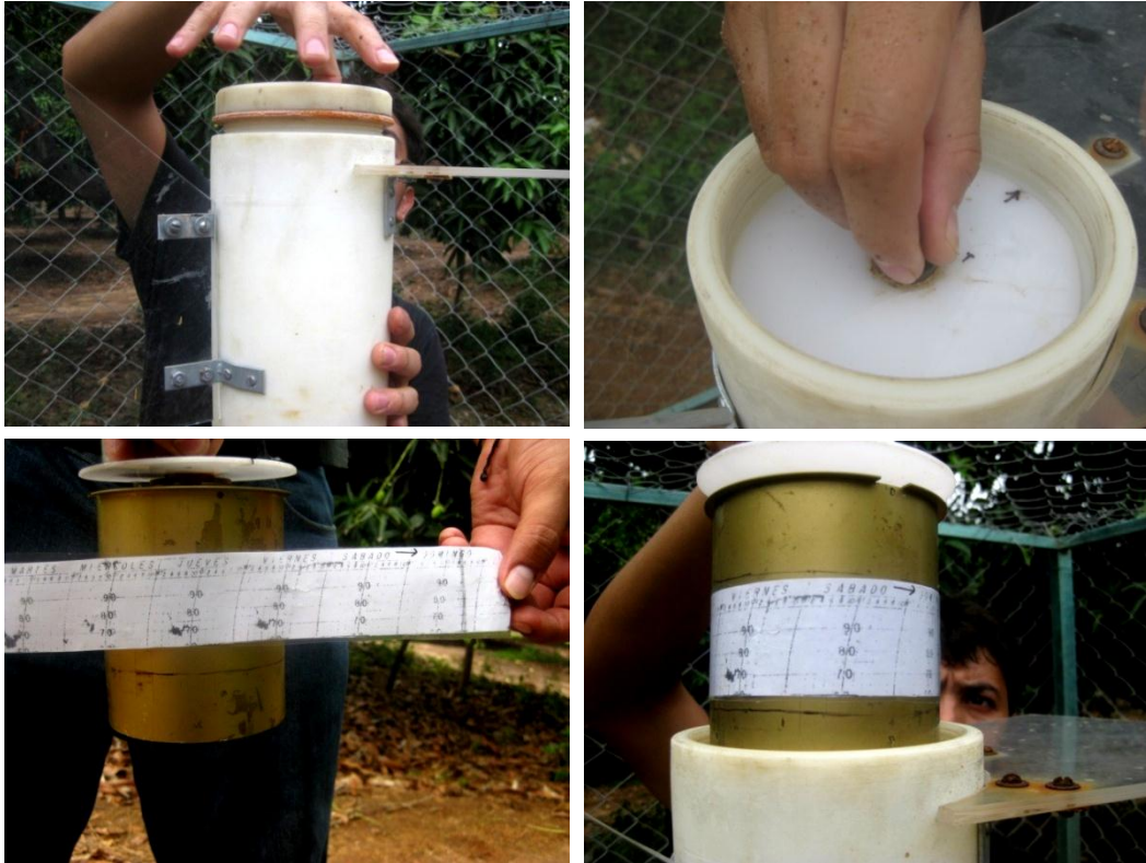
Anexo 4. Preparación de cintas y plantillas para trampa de esporas y diagrama que muestra la colocación de un tambor giratorio de higrotermógrafo con periodicidad a siete días. Las esporas se impactan sobre una cinta adhesiva que se ajusta alrededor del tambor.
