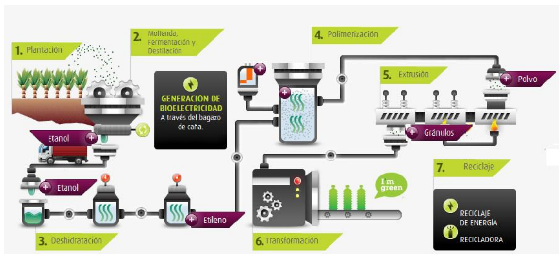
Figura 1. Proceso de producción del biopolietileno
