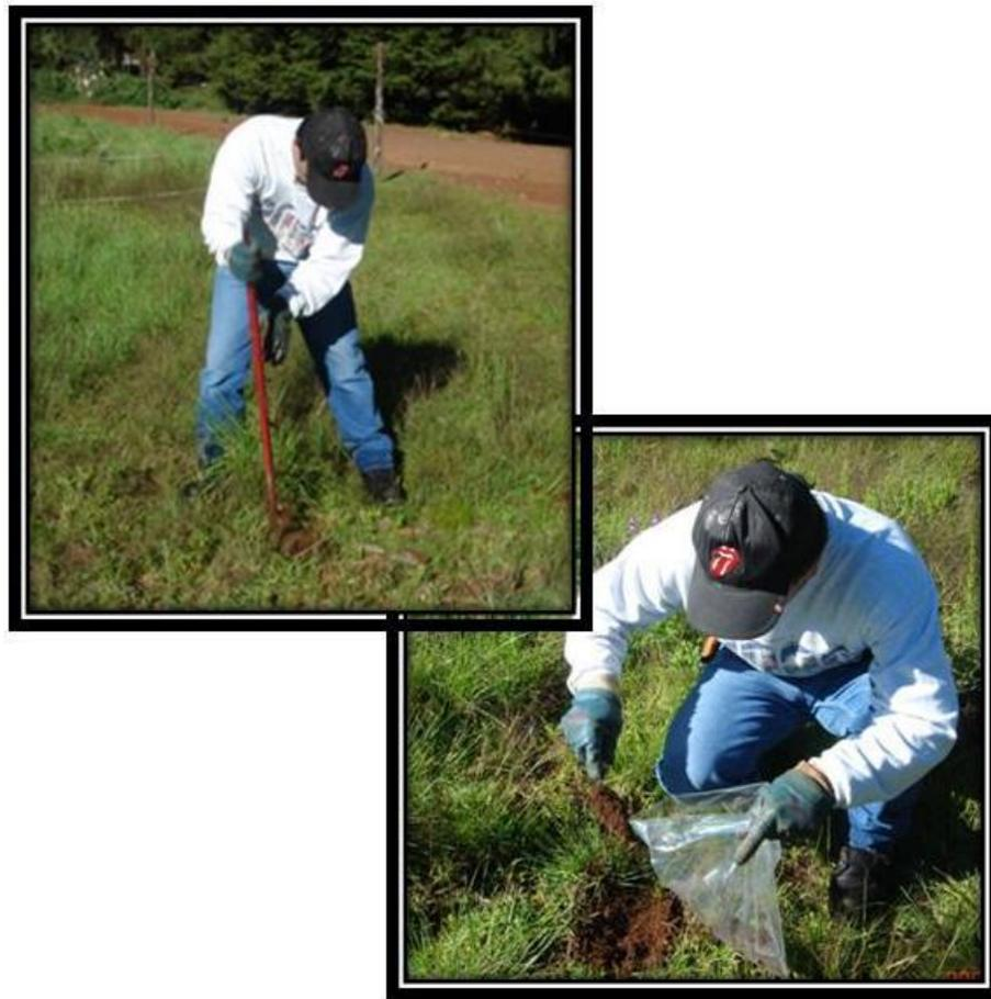
Figura 5. Fotografía del procedimiento seguido para la colecta de las muestras de suelo durante el desarrollo del estudio en el campo experimental del CEIEPASP en Chapa de Mota.
