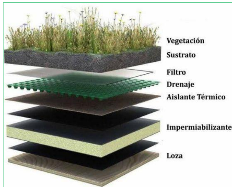
Figura 6. Estructura general de azotea verde
