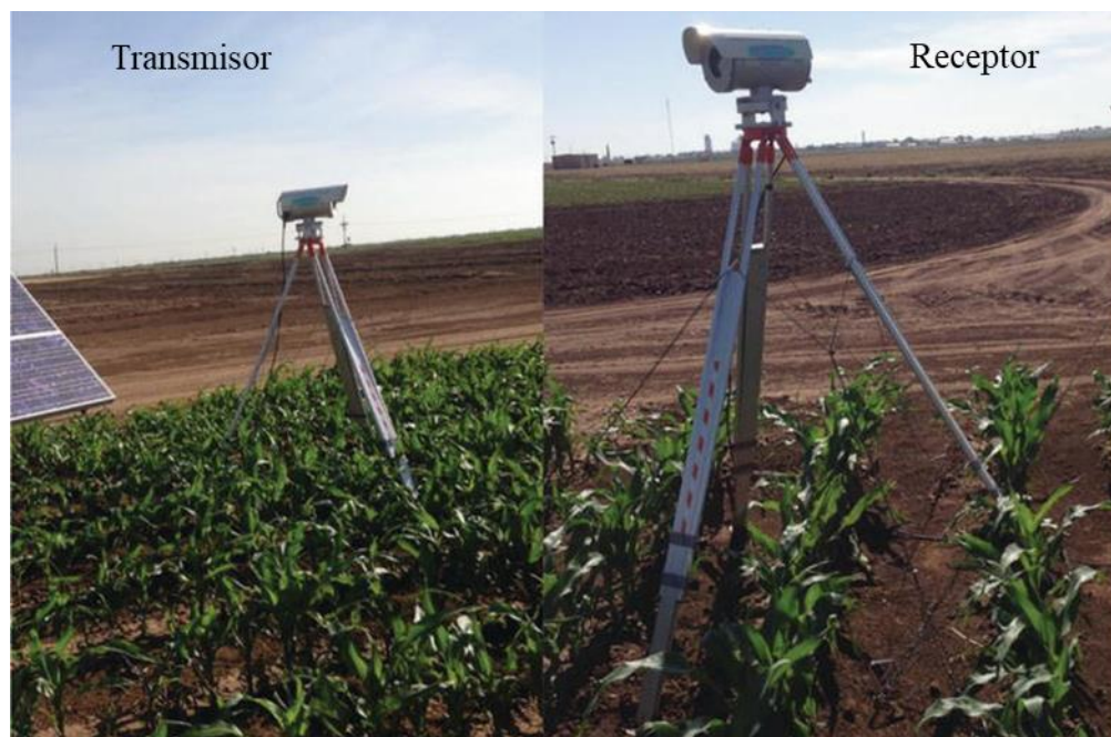
Figura 5. centelleómetros de gran apertura (J. E. Moorhead, 2018)
