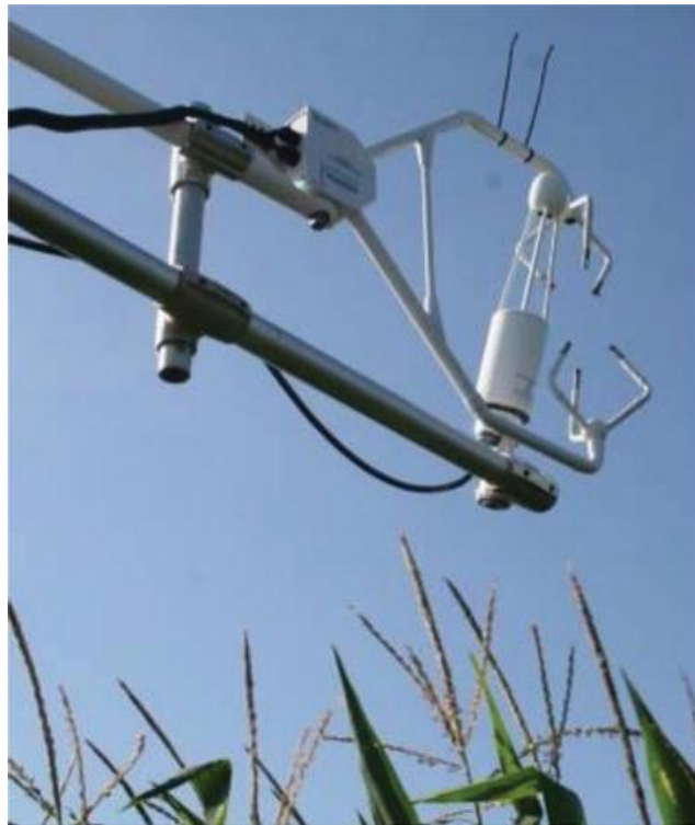
Figura 4. Sistema de Eddy covariance con un anemómetro sónico tridimensional (J. E. Moorhead, 2018).
