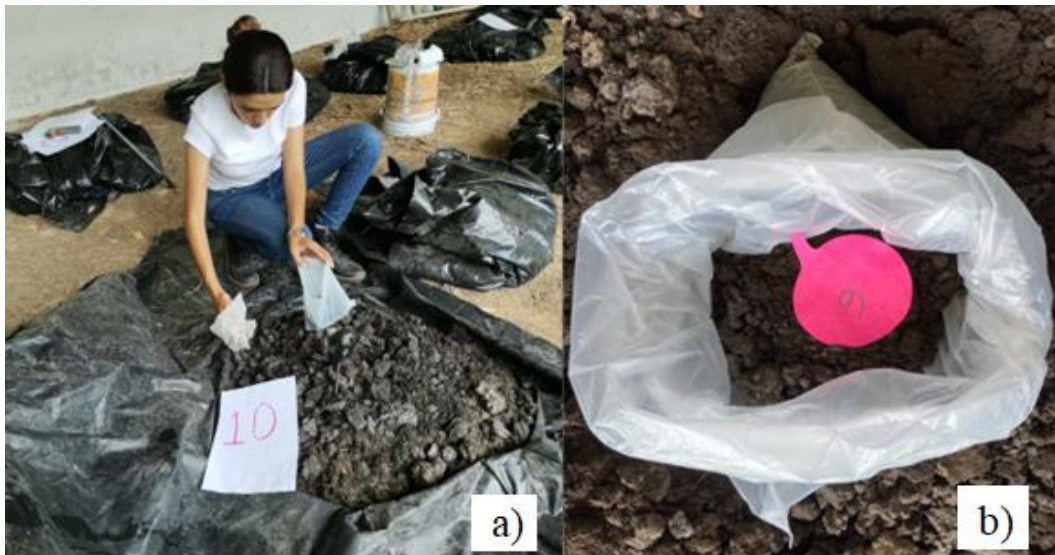
Figura 4. Proceso de toma de muestras: a) toma de muestra y b) rotulación de la muestra enviada a laboratorio cada 30 días.
