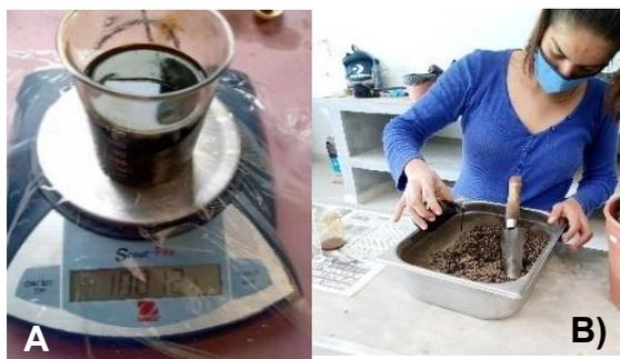
Figura 12. Preparación de suelo con dosis de petróleo fresco. A) Peso de petróleo en balanza semi-analítica. B) Mezcla de petróleo-suelo.
