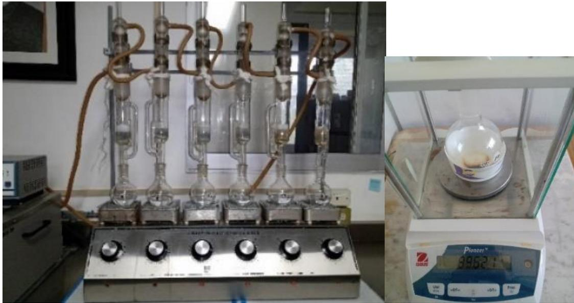
Figura 21. Extracción con equipo soxhlet y cuantificación gravimétrica de hidrocarburos totales de petróleo.
