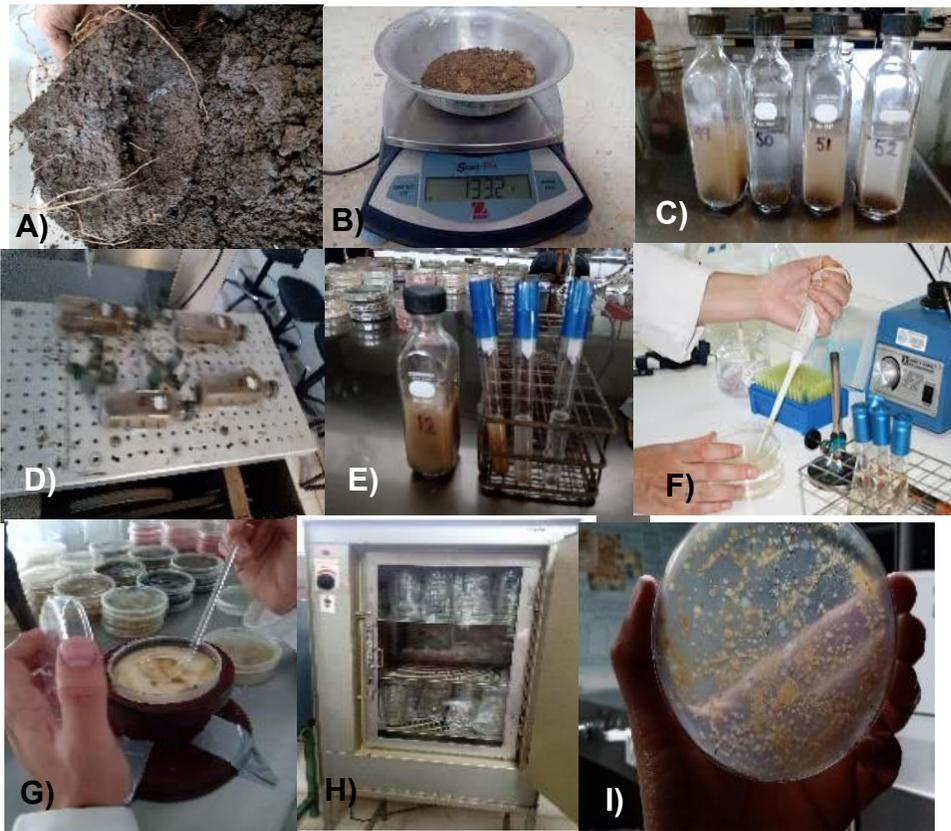
Figura 18. Procedimiento de cuenta viable por dilución seriada en placa de agar. A) muestras de rizosfera. B) Pesado de rizosfera. C) Dilución madre. D) Agitación. E) Dilución seriada. F) Alícuota en placa. G) Distribución de alícuota. H) Incubación. I) Conteo de UFC (Madigan *et al.*, 2015)
