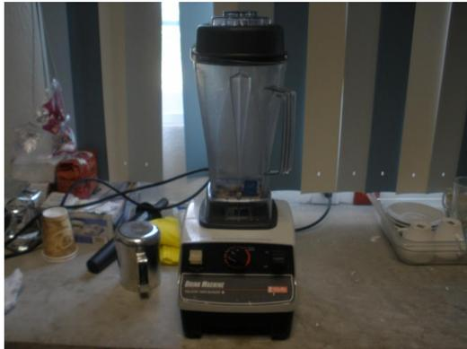
Figura 23. Procedimiento y equipo utilizado en la trituración del grano.
