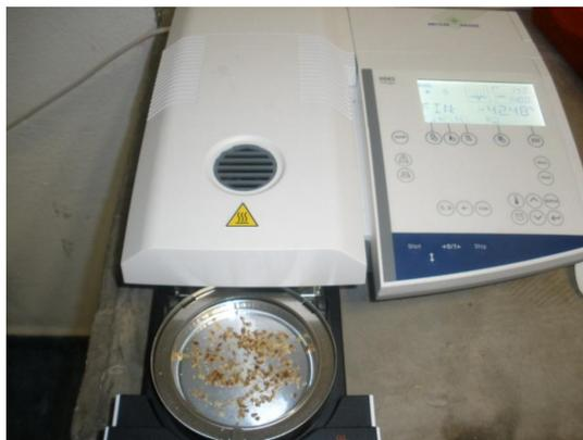
Figura 24. Determinador halógeno de humedad.
