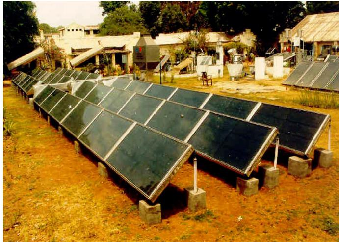
Figura 8. Secador solar de circulación forzada.
