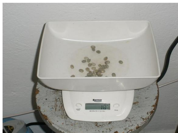
Figura.22. Bascula utilizada para pesar los 10 g de grano a analizar.
