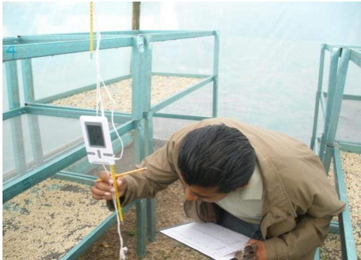
Figura 18. Toma de datos de temperatura en las camas y la humedad relativa.
