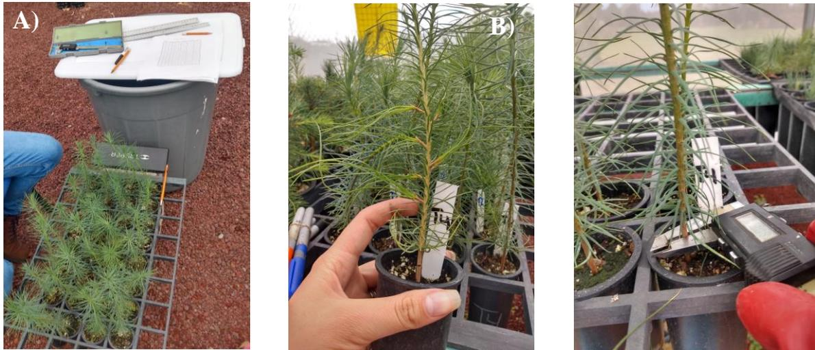
**Figura 1.6.** Toma de datos: diámetro y altura. A) Herramientas utilizadas para la toma de datos, B) Medición de altura, C) Toma de diámetro.
