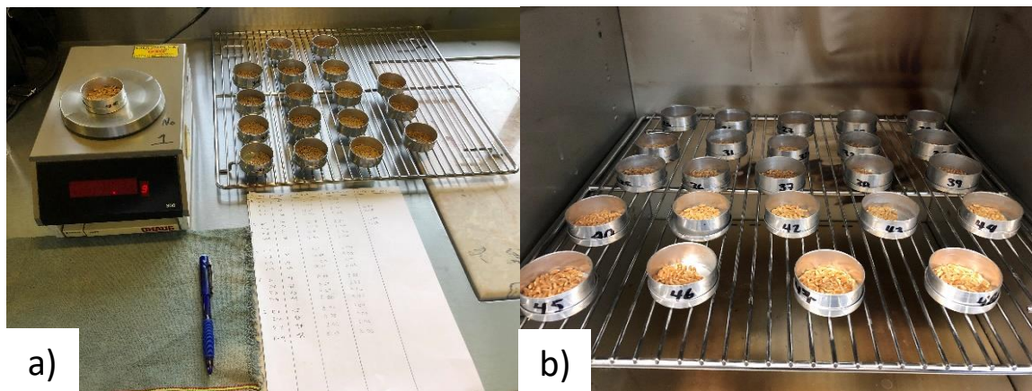
Figura 4. Evaluación del porcentaje de humedad: a) peso inicial, b) semilla después del secado.
