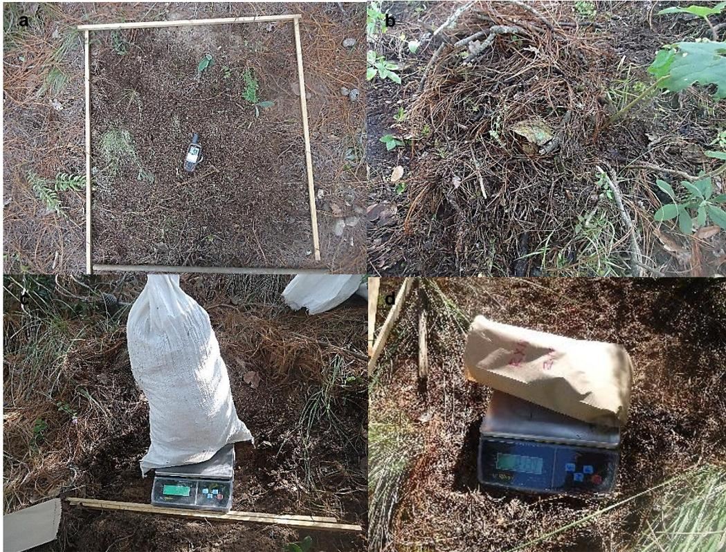
Figura 7. a. Subparcela de 1 m<sup>2</sup>, b. Biomasa que se juntó de la subparcela, c. Pesado de la biomasa y d. Pesado de la muestra llevada a la estufa de secado.
