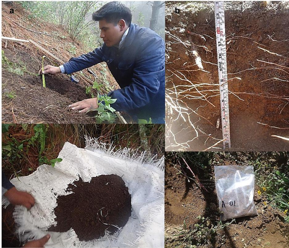
Figura 9. a. Punto donde se tomó la muestra de suelo, b. Profundidad, c. Combinación de las muestras de suelo tomadas en el sitio circular, d. Selección de la muestra llevada al laboratorio.
