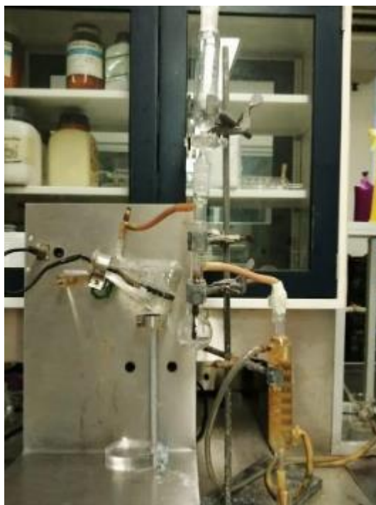
Figura 10. Destilador para determinación de nitrógeno total por el método de semi-micro Kjeldhal.
