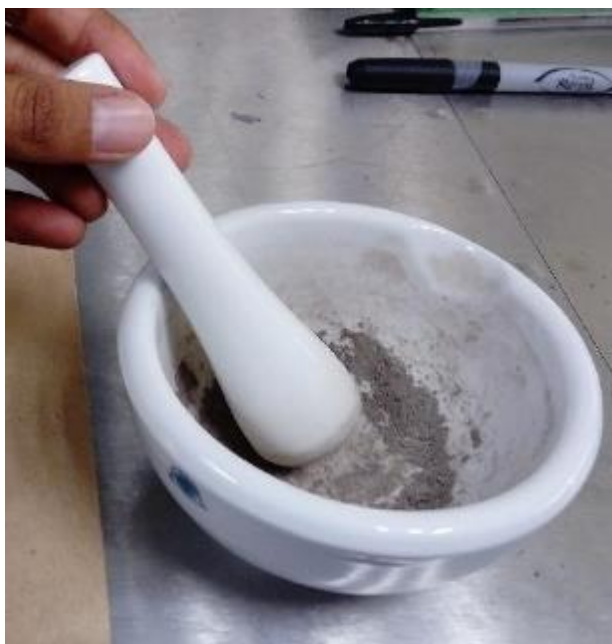
Figura 8. Molienda de biomasa seca de la parte aérea y radical de plantas de G. americana L. de forma manual con mortero.
