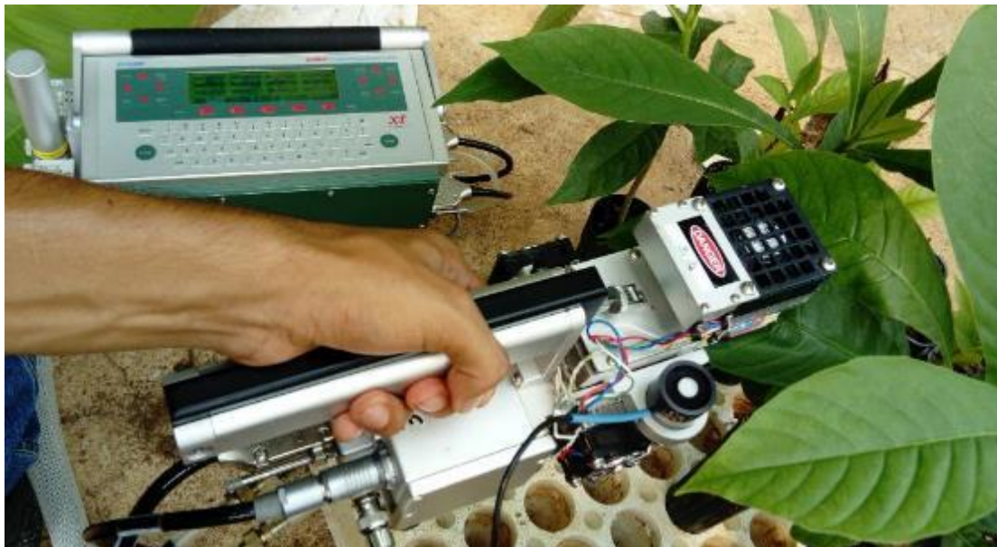
Figura 7. Medición de la tasa fotosintética en plantas de G. americana L. en vivero utilizando el LI-6400X.
