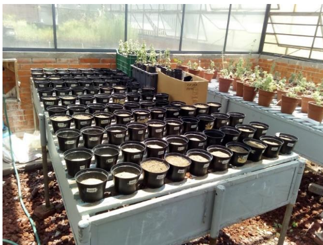
Figura 15. Experimento de adición de enmiendas al residuo de mina, estabilización por ciclos de humedecimiento y secado.
