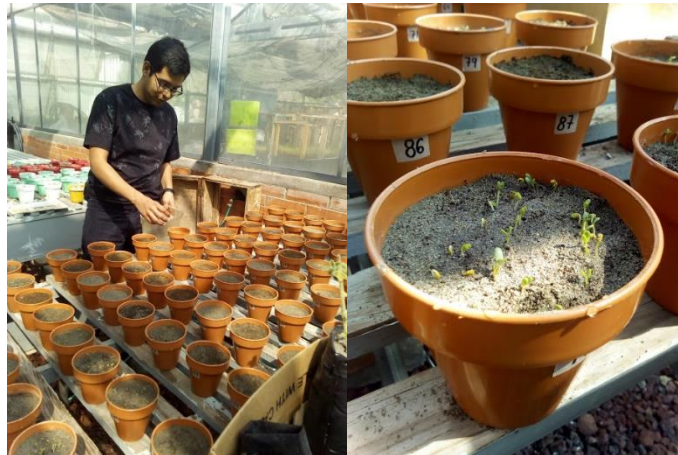
Figura 16. Siembra y germinación de las semillas de trébol en el residuo de mina.
