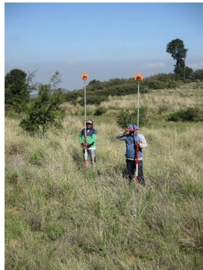
Figura 8. a) Placa de INEGI V150286 localizada en campo. b) colocación de mojonera para banco de nivel y toma de coordenadas. c) levantamiento de los vértices de cada árbol.
