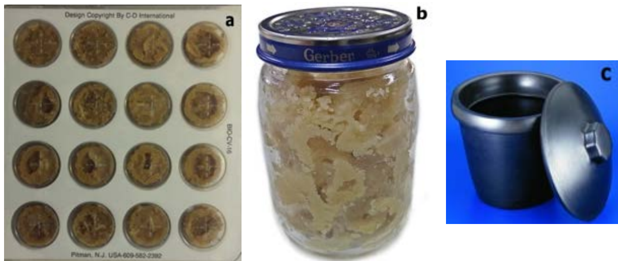
Figura 1. a) Charola de bioensayo de 16 cavidades con dieta comercial con tapa auto adherible; b) Frasco de vidrio tipo Gerber® con dieta comercial que muestra las galerías formadas por las larvas; c) desecador Magic Touch® ice bucket blue de PVC (Sigma-Aldrich, EUA).
