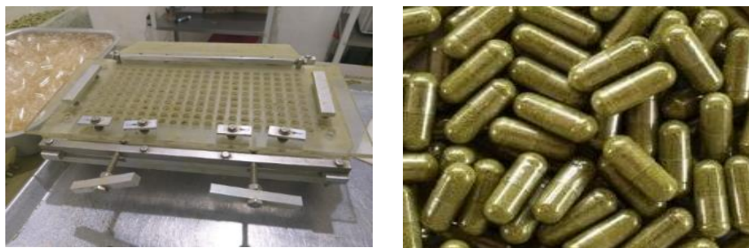
Figura 8. Encapsuladora y cápsulas con harina de moringa
