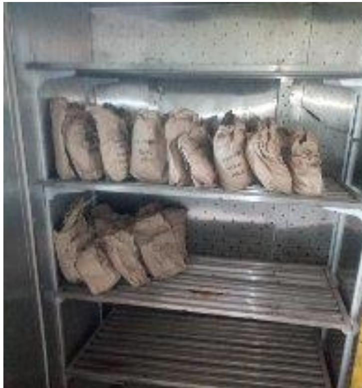
Figura 6. Secado de muestras de biomasa en estufa de aire forzado a 60 °C.
