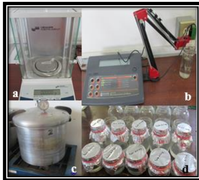
Figura 11. Equipo utilizado para la elaboración de medio de cultivo. a) Balanza analítica, b) Potenciómetro, c) Autoclave, d) medios de cultivo.
