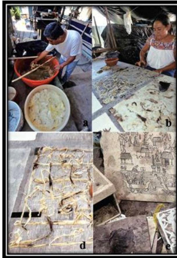
Figura 3. Elaboración del papel amate. a) Lavado de las fibras que fueron hervidas; b) Después del lavado de las fibras se extienden sobre una tabla de madera; c, d) se golpean con una piedra volcánica para formar pliegos; e) Secado y desprendimiento de las hojas (López, 2009).
