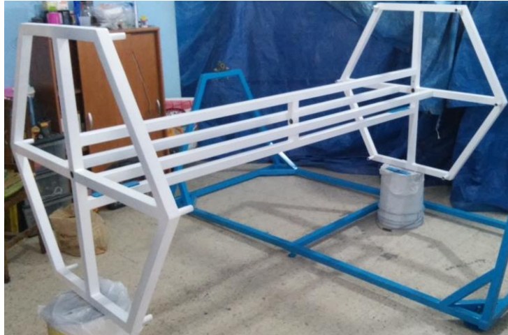
Figura 11. Hexágono metálico denominado revólver.
