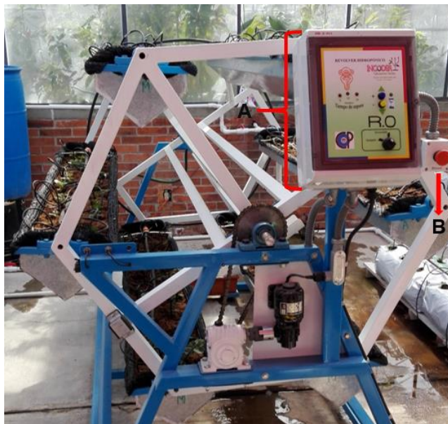
Figura 14. A: Gabinete de control; B: Paro de emergencia.
