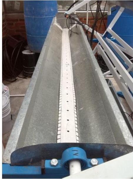
Figura 12. Canaleta triangular de acero inoxidable.
