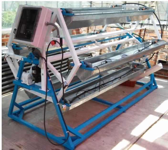
Figura 9. Vista general del sistema hidropónico cerrado tipo revólver.
