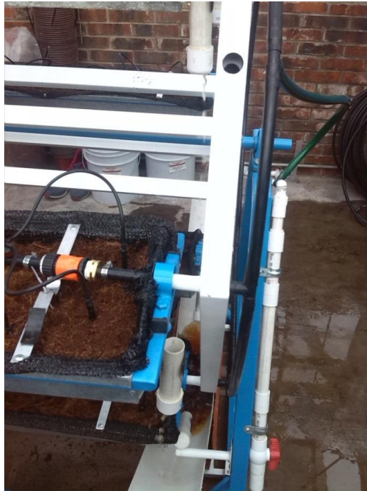
Figura 15. Desagües mecánicos (tubos y topes).
