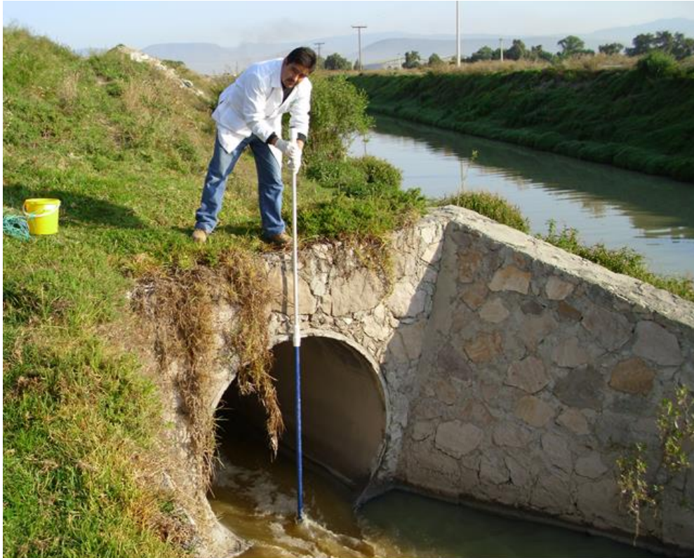
Figura 5. Medición de la velocidad del flujo de agua negra, emisor Venado.
