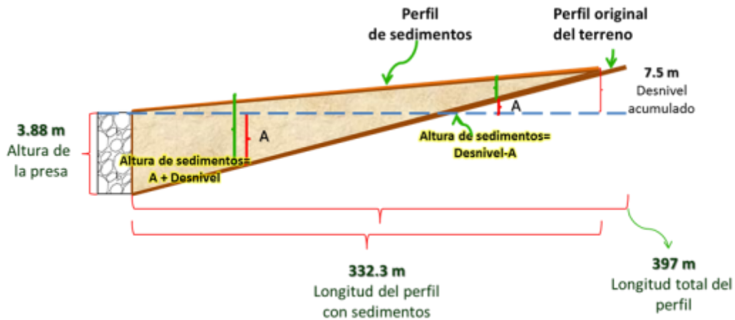
Figura 50. Esquema para el cálculo de la altura de los sedimentos.
