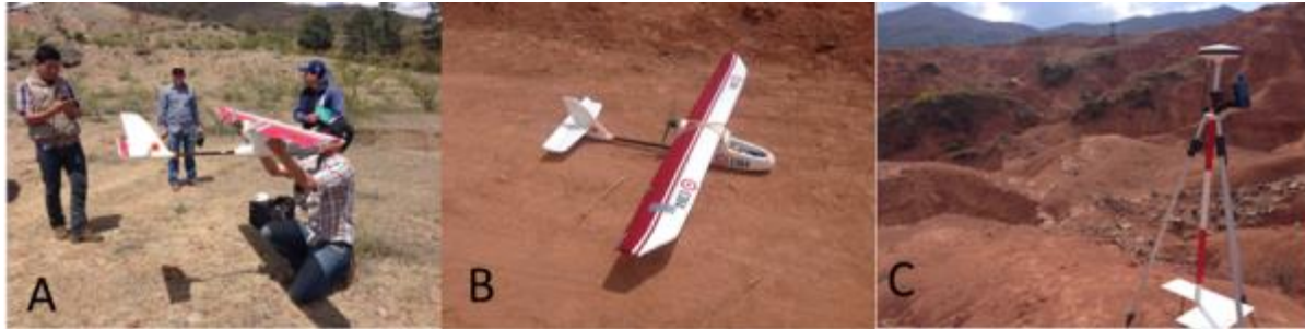
Figura 44. Vehículo aéreo no tripulado y GPS de precisión utilizados en el área de estudio
