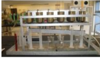
Figura 49. Conductividad hidráulica estimada con el permeámetro de carga constante
