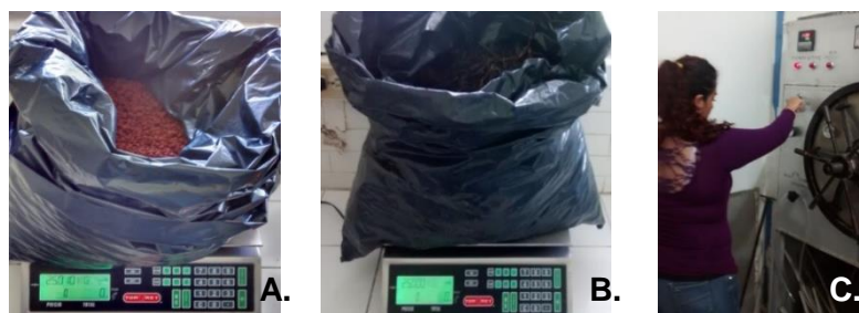
Figura I. 3 Sustratos tezontle (A) y composta (B) pesados en báscula TORREY® modelo MFQ-40 Aut. No. 2907 Monterrey N.L.). y (C) esterilizados en autoclave (1 atm de presión, 121 °C).
