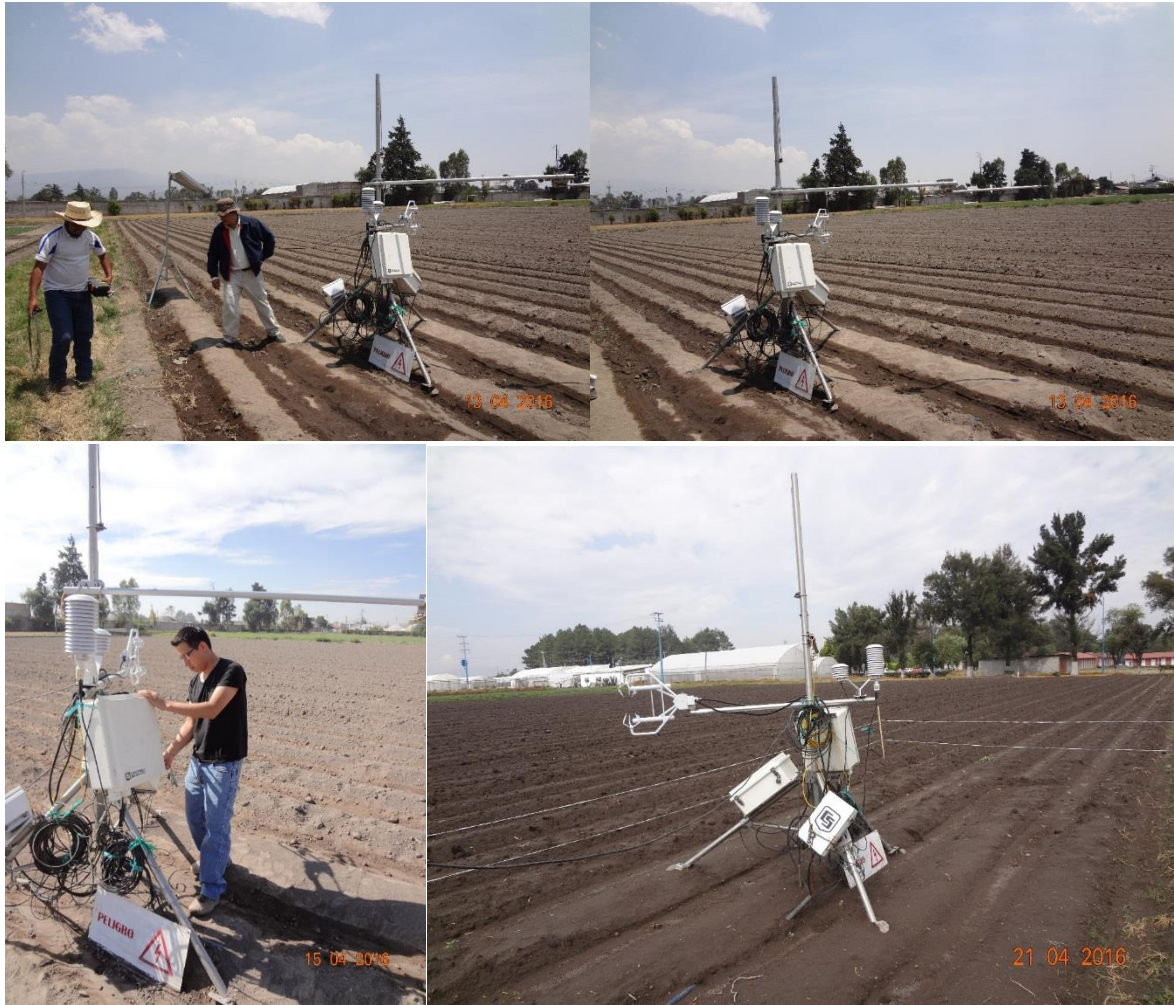
Figura 13. Instalación del sistema Eddy covariance.
