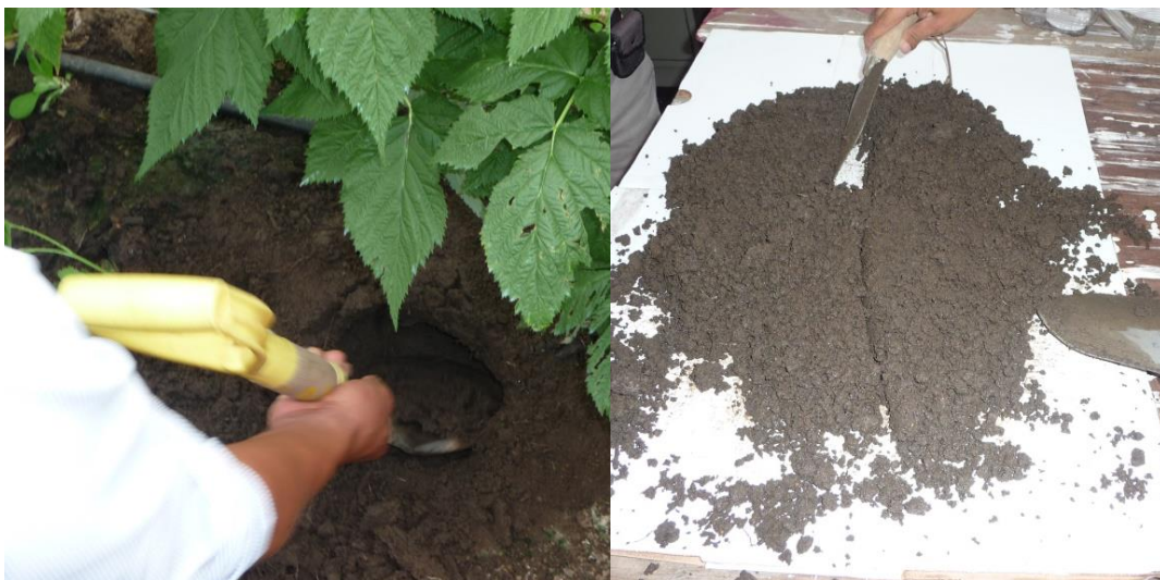
Figura 14. Muestreo y formación de muestra compuesta de suelo para su análisis.
