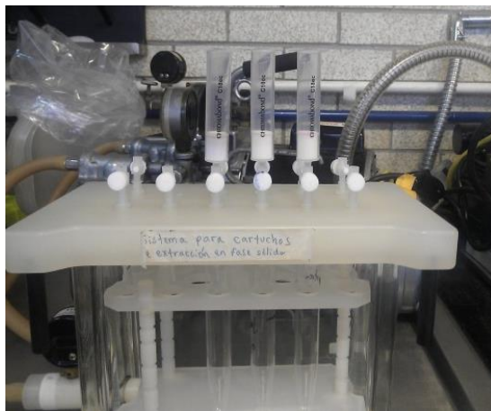
Figura 21. Acondicionamiento del cartucho con MEOH y H 2 O.
