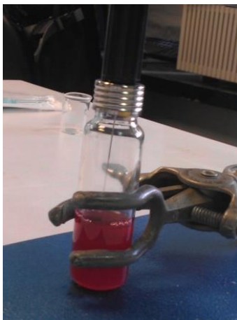
Figura 29. Exposición de la fibra al espacio de cabeza, después del equilibrio de fases.
