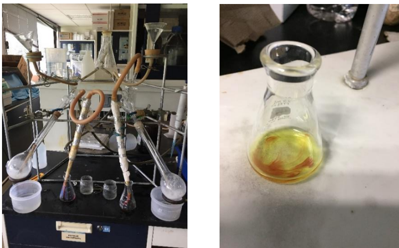
Figura 11. Determinación de NO_3^- y NH_4^+ por arrastre de vapor y determinación de cloruros.
